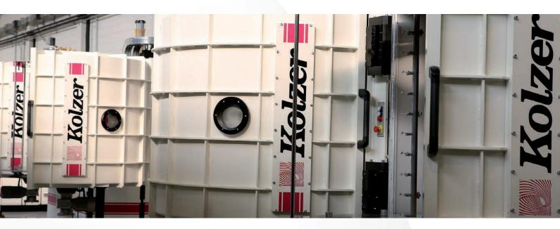
I macchinari Kolzer sono semplici da usare, forniscono rivestimenti a base PVD Sputtering. Sono completamente automatizzati, digitalizzati e manovrabili anche da remoto. La macchina integrata con una linea di verniciatura UV, consente alti volumi di produzione in camera pressurizzata, in linea con le specifiche del cliente e con bassissimi scarti di produzione. Lo storico delle
