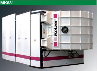
La macchina MK è simbolo di innovazione, praticità e design. Dal duplice carico e scarico, manuale o automatico direttamente sulle porte, al software Windows facile da usare, l'intero ciclo produttivo è veloce e privo di complessità. Questo sistema PVD Sputtering verticale offre una tecnologia PVD Plasma PECVD "combinata" in una sola macchina, in grado di ottenere la massima flessibilità e creatività.
