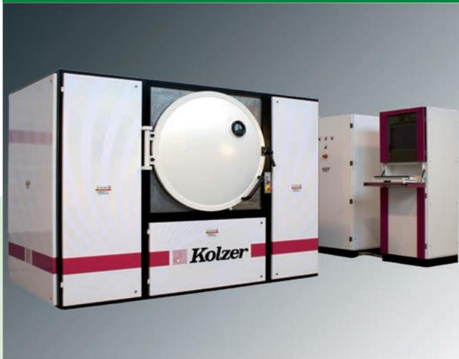
Toda la tecnología PVD Kolzer User Friendly tiene un **"price entry" facilitado**. El modelo DGK permite obtener un excelente resultado con tiempos de ciclo muy reducidos. La máquina está dotada de doble carro de carga para facilitar la carga y descarga e integrar la logística con la línea de barnizado UV. Las características de los equipos pueden ser personalizadas en función de las exigencias productivas.
