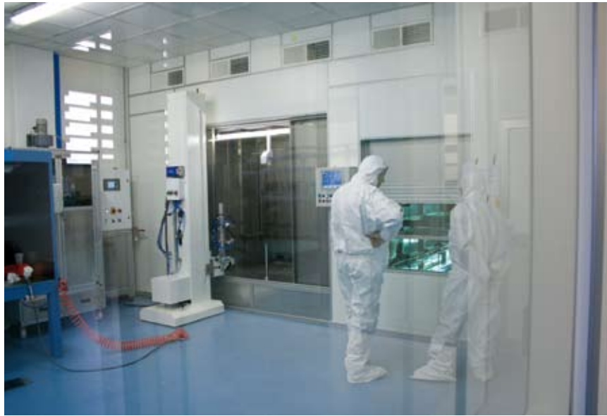
6 - L'impianto di applicazione e il forno di polimerizzazione UV del primer organico su cui deposita il metallo di acciaio inox, di nichel, di cromo e altro in camera sottovuoto e in ambiente di plasma, illustrata qui sotto.
