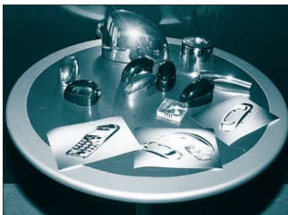
1 - Alcuni pezzi rivestiti in laboratorio con il processo Cromless: si nota il buon risultato della cromatura organica di piccoli radiatori e altri pezzi. Furono presentati nell'ambito del convegno Cromless 2001 dell'Anver.
