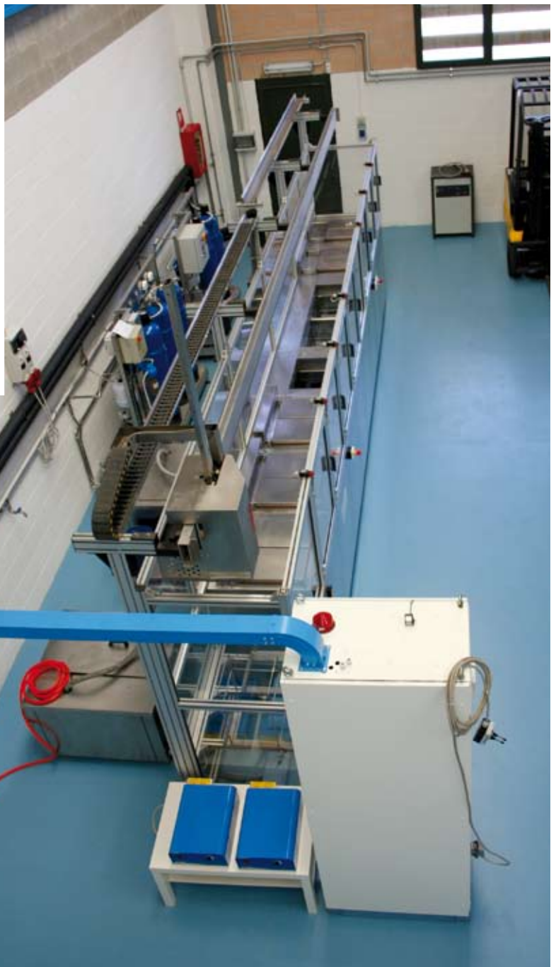
12 - Vista dall'alto delle vasche di lavaggio durante la fase di trattamento alla cromatura metallorganica.
