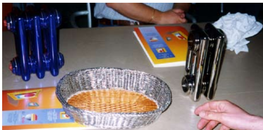
1 - Alcuni pezzi rivestiti in laboratorio con il processo Cromless: si nota il buon risultato della cromatura organica di piccoli radiatori e altri pezzi. Furono presentati nell'ambito del convegno Cromless 2001 dell'Anver.
