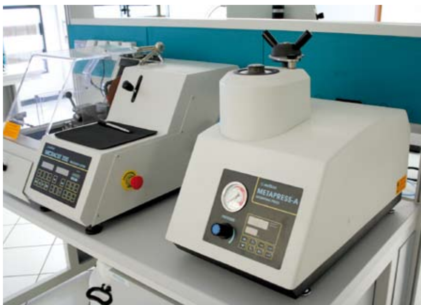
17 - A sinistra, una microtrancatrice per tagliare il pezzo e sezionare con precisione lo strato di vernice e di metallo applicato. In primo piano, una inglobatrice (in un cilindretto) del film sezionato, per analisi qualitativa dello strato al microscopio.
