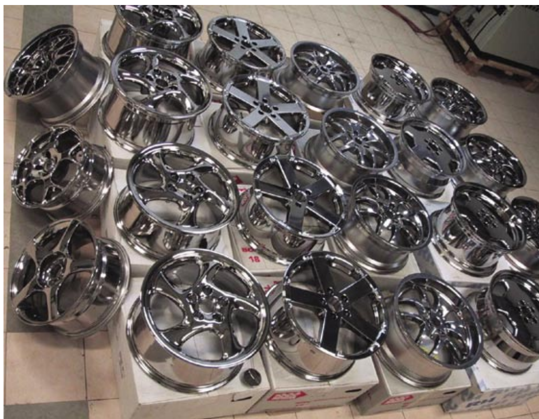
Fig. 1 - Un bell'esempio di ruote in lega leggera trattate con la tecnologia, tipo sputtering, di perfetta imitazione della cromatura galvanica
